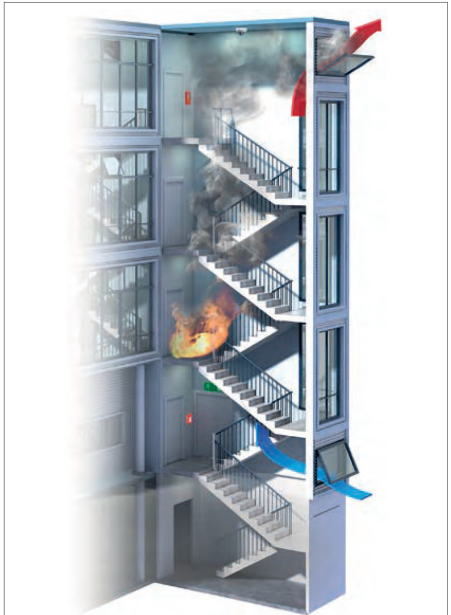
Yhdistetty uloskäynti ja savunpoistoluukku Orivent 01 (moottoritoiminen) asennettuna Orivent savunpoistokuilun päälle
